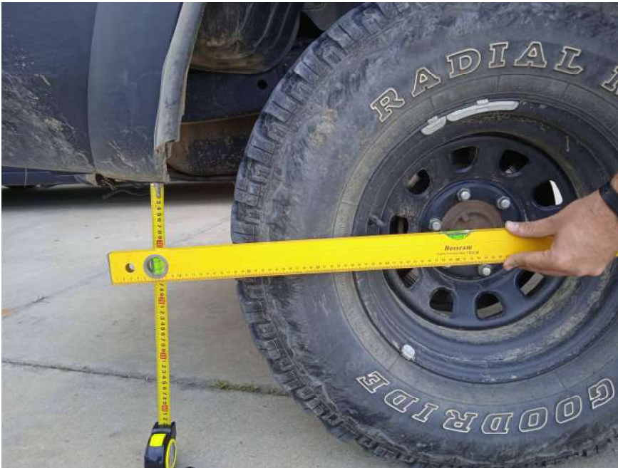
FORMA DE MEDIRLO (ARRIBA con nivel) ABAJO (restando)
