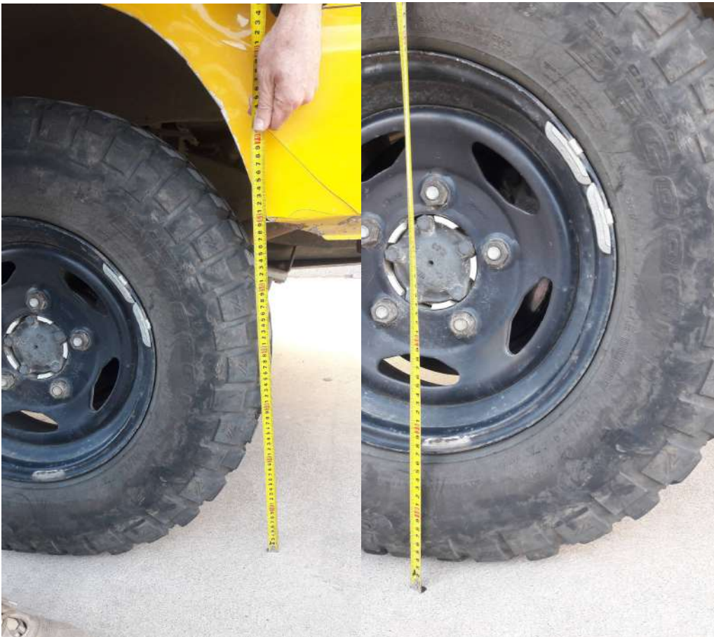
FORMA DE MEDIRLO (ARRIBA con nivel) ABAJO (restando)
