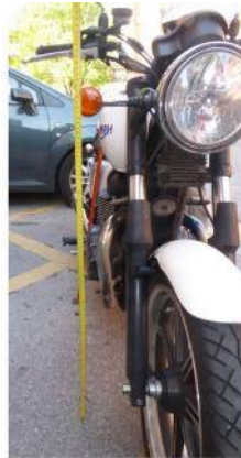
Altura al suelo de Intermitentes delanteros
