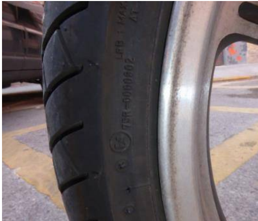
Contraseña de homologación del neumático
