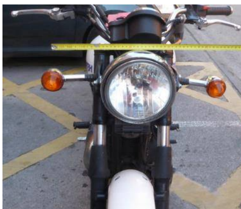
Distancia entre intermitentes delanteros y traseros
