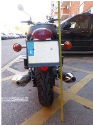
Altura al suelo de Intermitentes y matrícula
